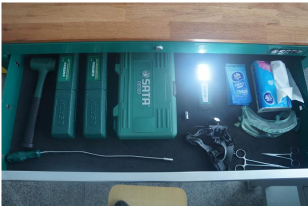
第一层摆放世达扭力扳手（型号分别为 96311 和 96312）、世达聚头灯、世达工作灯、钳子、抽纸等。
