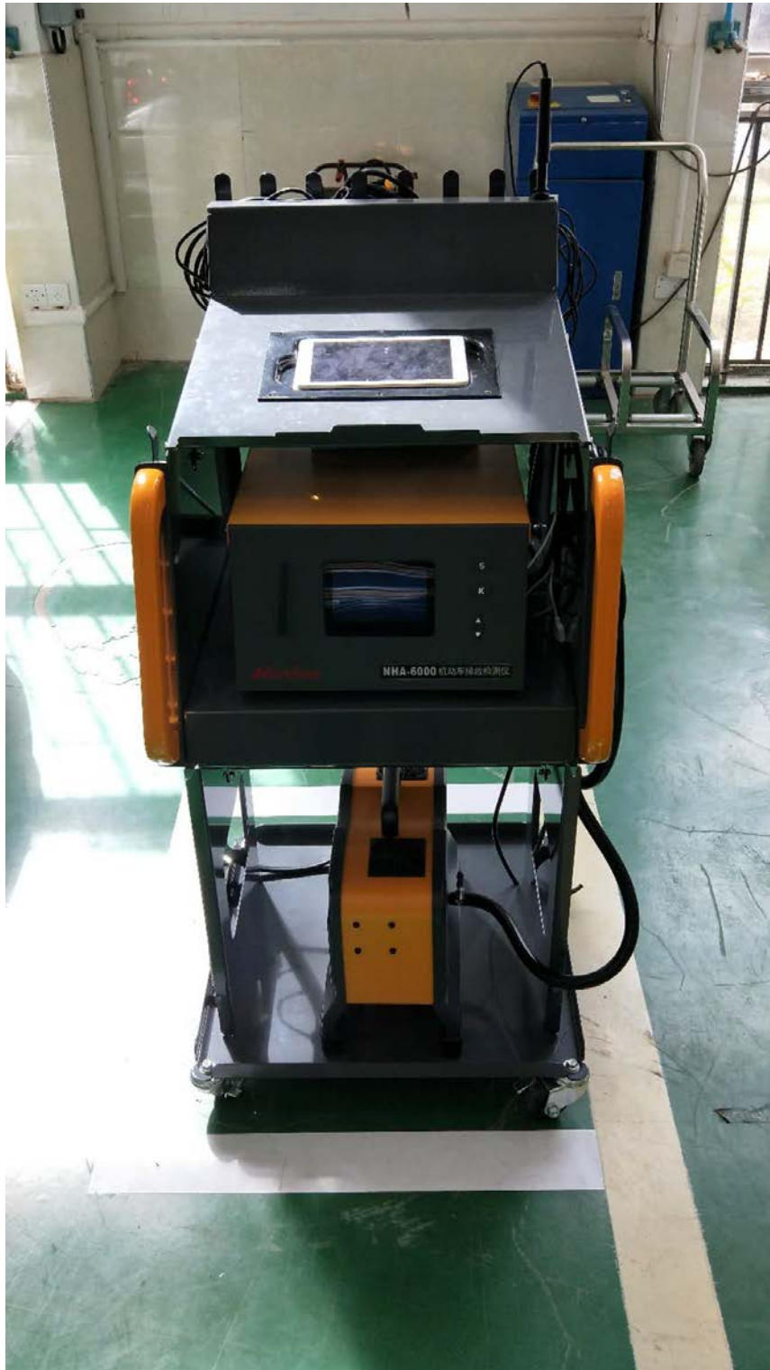
图 5 故障诊断工位尾气分析仪照片
